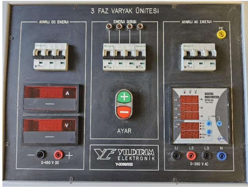
EK 1. 3 Faz Varyak Ünitesi
